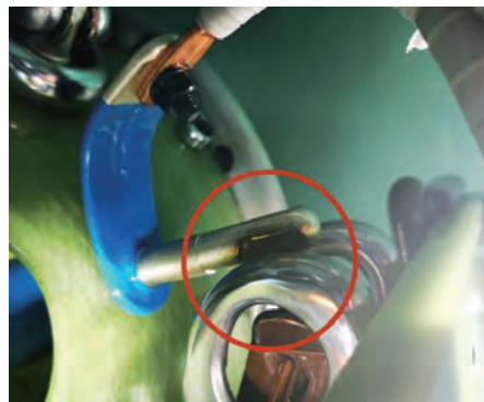
图4 分接开关选择器K+接触不良
