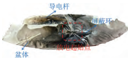
图10 盆式绝缘子放电起始位置
