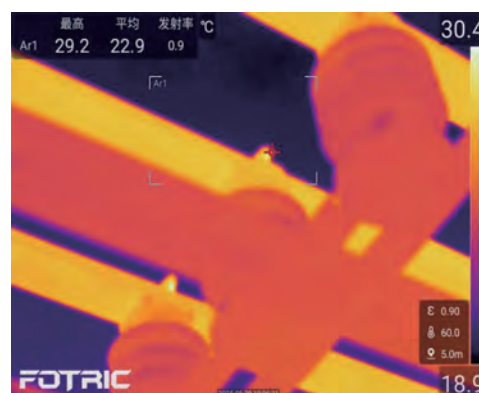
图1 1号主变35 kV母线排电流回路红外测温图谱
