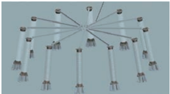
图7 辐射筋支架地面安装示意
