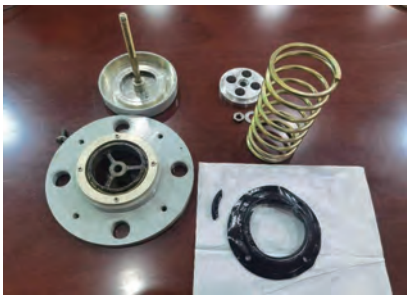
图2 密封圈断裂情况
