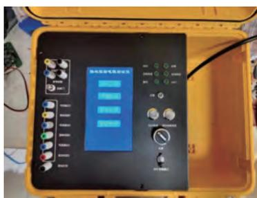
图4 高压电缆接地回路电阻带电检测装置
