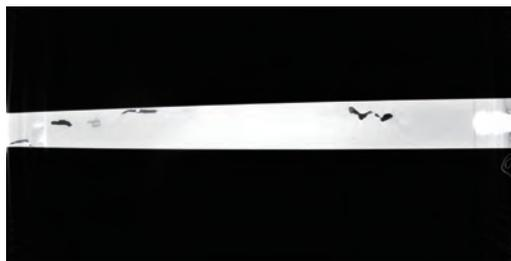
图16 1183隔离/接地开关C相绝缘拉杆存在5处低密度区
