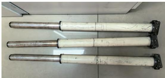
图14 1183隔离/接地开关更换下来的绝缘拉杆
