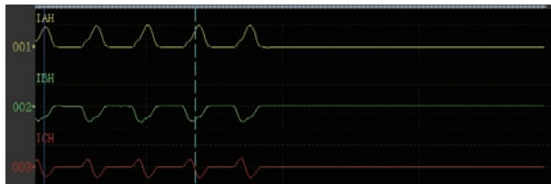
图2 2号主变差动保护高压侧电流故障录波
