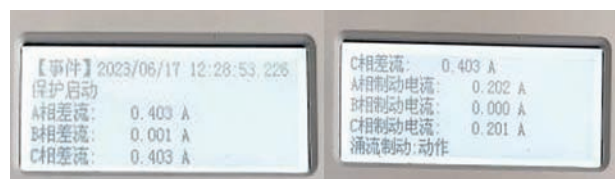
图6 差流大于0.4 A时涌流制动判据正常动作
