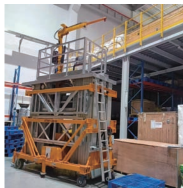
图5 电容器专用更换平台
