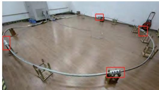
图6 跳线接续线夹电阻、温升热循环试验布置图
