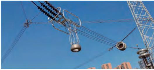
图7 1 000 kV 装配式耐张串及跳线接续线夹试验布置图
